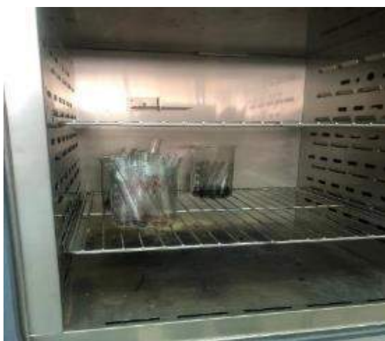
Evaporización a 160°C por 34 minutos
