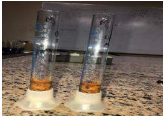
Visualización de hinchamiento del pulverizado
