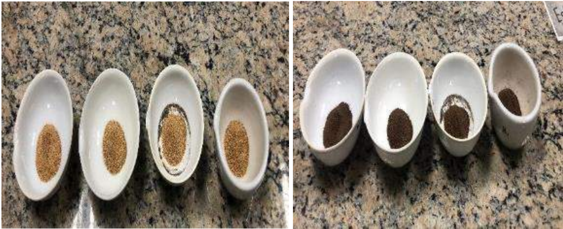
Muestra antes de ingresarla en la mufla Muestra sacada de la mufla
