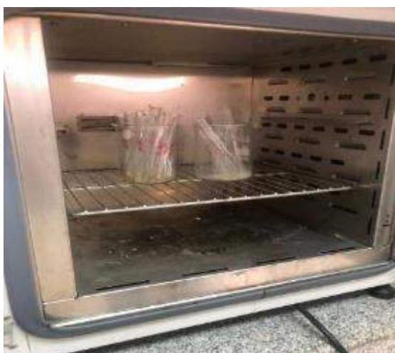
Evaporización a 160°C por 34 minutos
