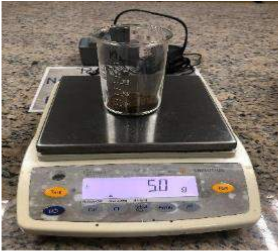
Peso de 5g de pulverizado para pH
